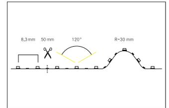
QualityFlex BB-Flexplatine 5 m, CRI > 80, 9,6 W / m, IP00, LED-Weißlicht, 3000K, CRI > 80 LED-Flexplatine Länge: 5000.0 mm
