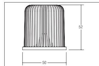
LED-Reflektoreinsatz MR16, 8 W, TunableWhite, 24 V DC, rund Anschlussleitung: 3-adrig, Ansteuerung: negativ, gemeinsame Anode (C.A.). Lichtstrom: 318 lm bei 2000 K, 374 lm bei 4000 K, 415 lm bei 6500 K. Material: Aluminium / Glas, Schutzart: nach DIN EN 60529: IP20, Schutzklasse: (EN 61140) III, Spannung: 24V, Leistung: 8W, Anzahl der Leuchtmittel / Fassungen: 1.0 Stk, Lichtstrom: 700lm, Farbtemperatur: von 2000 K bis 6500 K, Abstrahlwinkel: 60°.
